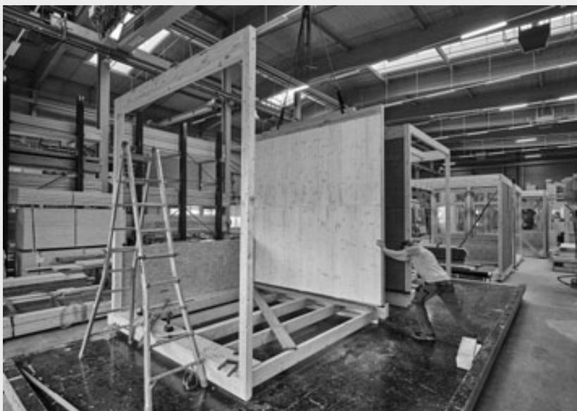
Dans le module Sprint, le bois réutilisé de diverses origines est à nouveau utilisé. Le bois de construction, qui n'a que dix ans, a été transformé en modules de bois dans l'usine de charpente de HUSNER AG Holzbau.
