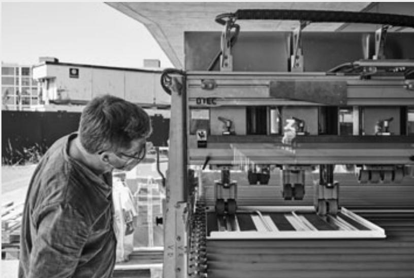
*Le plafond acoustique du module a été transformé en plafond chauffant et rafraîchissant. Au cours de ce processus, les lignes de cuivre ont été pressées sur les éléments acoustiques à l'aide d'une machine mobile spécialement conçue à cet effet.*
