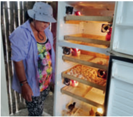
Luz Perla Cardoso devant l'incubateur pour poussins, un réfrigérateur désaffecté. La lumière chaude est obtenue avec du tissu autour des ampoules, la ventilation est assurée par de vieux ventilateurs d'ordinateur.
